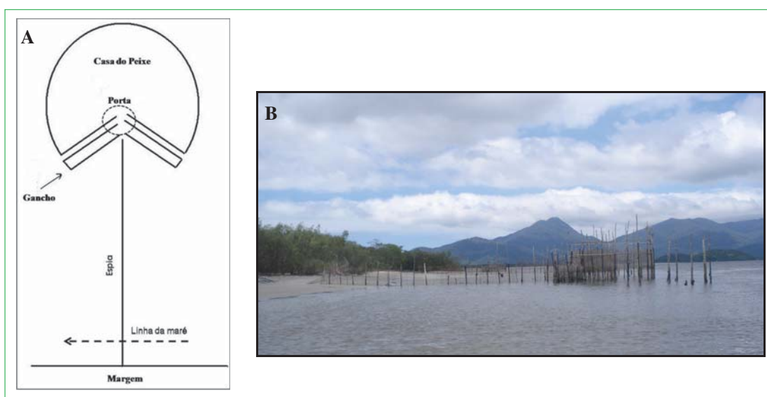
FIGURA 2: a) Desenho esquemático de um cerco-fixo; b) Cerco-fixo localizado na região da Ponta da Trincheira (Ilha Comprida) (Foto: Projeto Tartarugas / IPeC).
